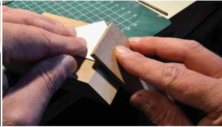
Links: Het meegeleverde blokje MDF en een plaatje hout waar nr 400 schuurpapier op gelijmd werd om het recht schuren te vergemakkelijken. Rechts: Het schuren van de wanden.
